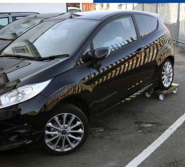
Le chariot Skate est particulièrement recommandé sur des interventions de dépannage sur la route ou sur les pistes d'un aéroport lorsque la roue du véhicule ou de l'aéronef est inutilisable ou manquante.
